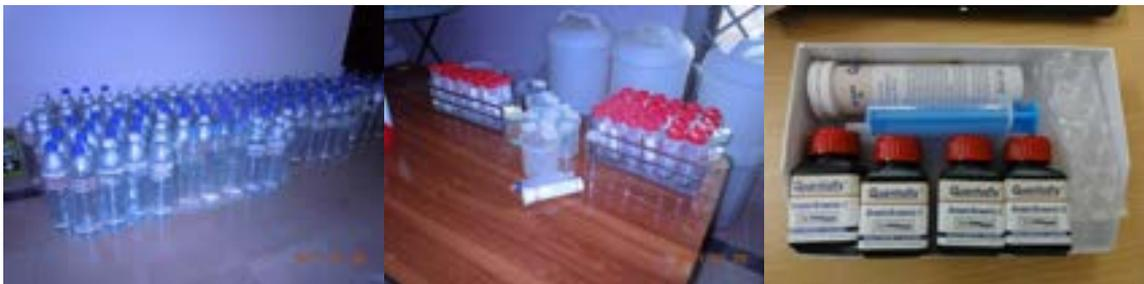
(注) NICCO の説明によると、重点的にヒ素の検査を行うほか、水の純度や塩素濃度等の検査も行っており、今後必要に応じてその他検査も行う予定とのことである。写真右は QUANTOFIX 社製の Arsenic 10 で、日本人の水専門家が人為的にヒ素溶液を作成し性能を確認したところ、正確であることを確認したとのことである。
