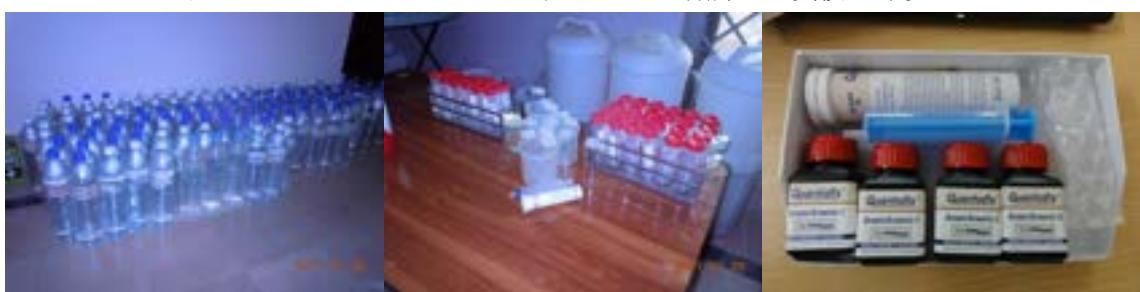
(注) NICCO の説明によると、重点的にヒ素の検査を行うほか、水の純度や塩素濃度等の検査も行っており、今後必要に応じてその他検査も行う予定とのことである。写真右は QUANTOFIX 社製の Arsenic 10 で、日本人の水専門家が人為的にヒ素溶液を作成し性能を確認したところ、正確であることを確認したことである。
